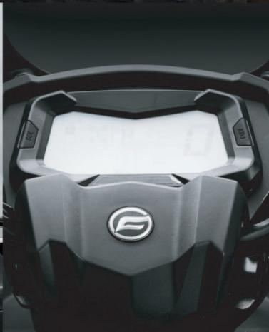
L'indicatore digitale a LED LCD da 5 pollici ti permette di controllare comodamente tutte le informazioni disponibili del veicolo. Il cupolino, che include un parabrezza e robusti paramani, aiuta a proteggere la strumentazione e il pilota.
