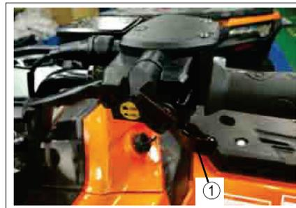
Prima di avviare il motore, controllare la leva dell'acceleratore ① per essere sicuri che sia in funzione senza intoppi. Assicurarsi che ritorna nella posizione iniziale, non appena si rilascia la leva.
